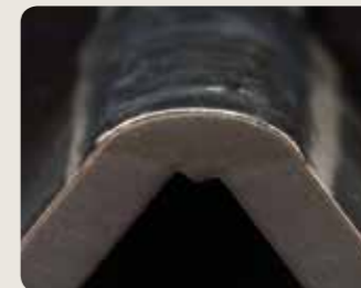
En stabil bue sørger for en jevn sveis og godt feste til grunnmaterialet, og sørger dermed for gode mekaniske egenskaper for skjoten.
