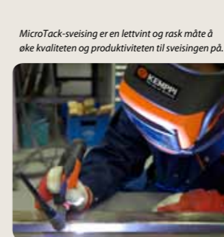
MIX TIG-funksjonen kombinerer de gode kvalitetene ved likestrøm og vekselstrøm. Det gjør det lett å skjote aluminiumslegeringer og reduserer antallet deformasjoner.
