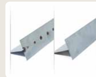
Forskjellen i heftsveiene er klart synlige. MicroTack ble brukt til å sveise stykket til høyre, og vanlig TIG ble brukt på stykket til venstre.
